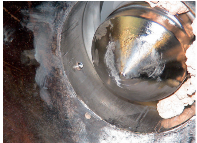
Bild 2. Die Spitze der Messsonde ragt in den Extruder hinein, um die Linse mit Schmelze zu bedecken
