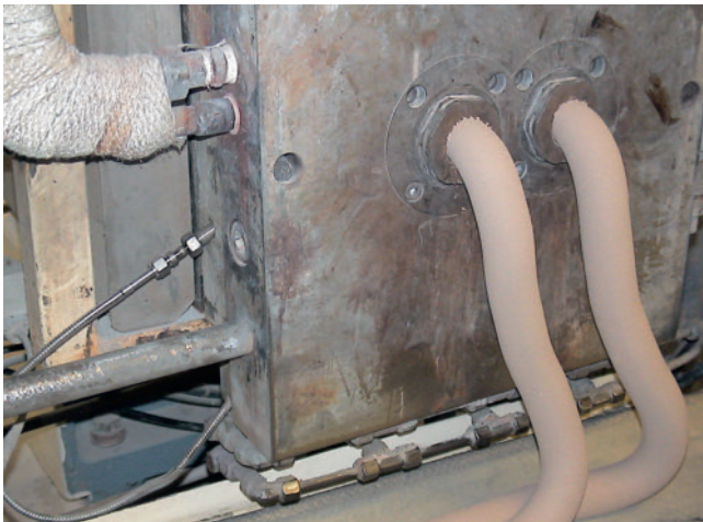
Bild 1. Die Extrudersonde (links) wird seitlich am Extruderausgang eingeschraubt
