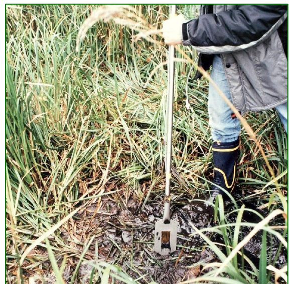
Anwendungsbeispiel: Messung an Sediment. Sensorfolie in einem Metallrahmen in Spatenform wird in das Sediment gesteckt
